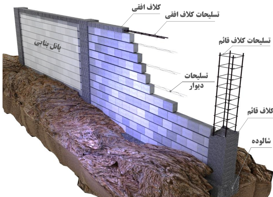
شکل ۱-۲ - قسمت‌های اصلی دیوارهای محوطه بنایی
