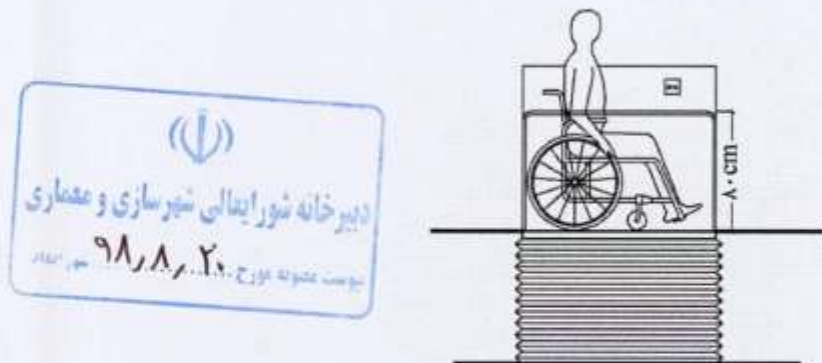
شکل شماره ۶۶: بالابر عمودی برای طی ارتفاع کمتر از ۲۰۰ سانتیمتر
