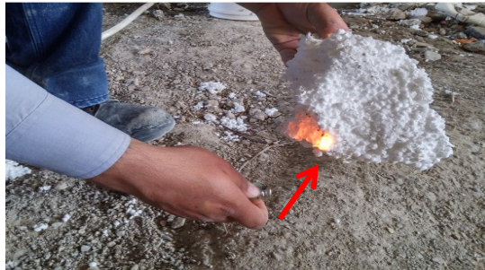
شکل ۱۸. شعله و ماندن بلوک پلی استایرین پس از دور کردن منبع آتش در شکل دیده می شود.
